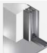
F: Montage in de dag met afdekljst buiten
